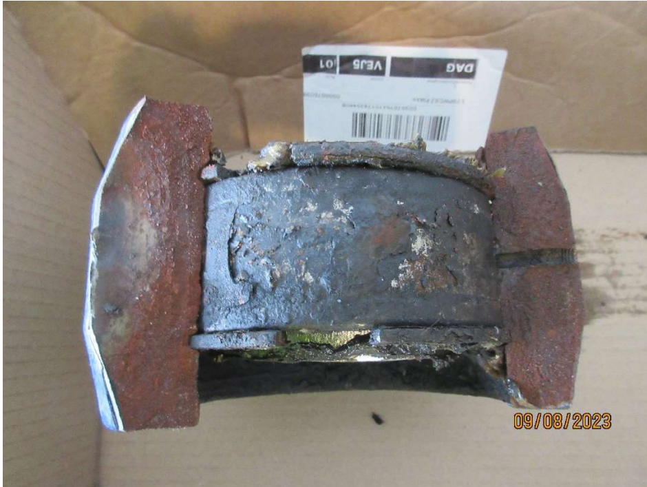
Foto 5: Reduktionen af det lastbærende areal er sket over tid. Det eksakte tidsrum er ikke muligt at angive, men jeg vil vurdere at der er tale om måneder hvis ikke år.
