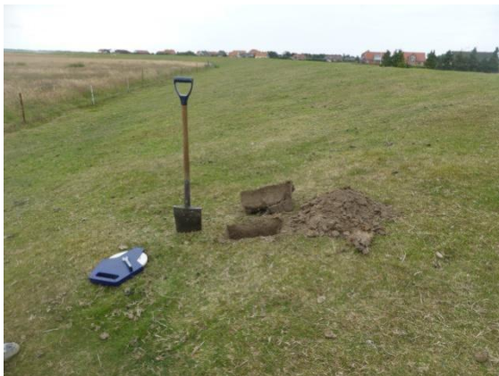
Eksempel på prøvegravning mellem st. 270 og 700 på nord-diget
